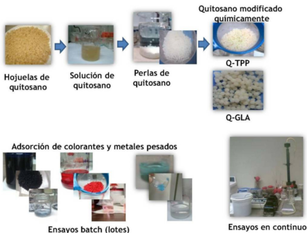
Figura 2 Metodología para la adsorción de iones metálicos y colorantes con perlas de quitosano
